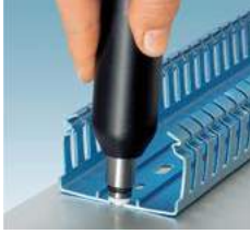
RVT-PA... perçin ve UNIFOX-RVT P... perçinleme aleti
